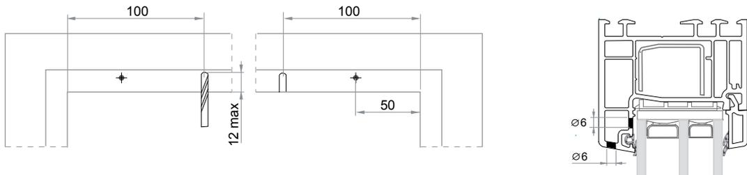
**15.2 Отверстия для удаления воды при глухом остеклении**
