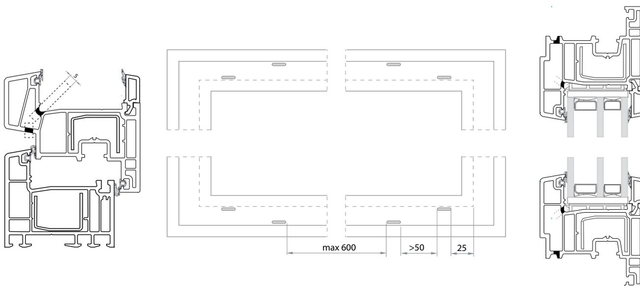
**15.6 Схема выполнения дренажных отверстий для профиля импост**
